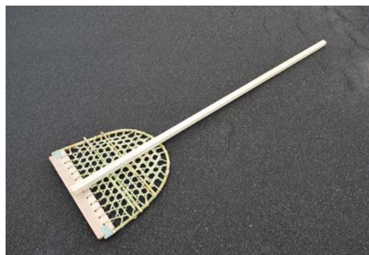
写真2 K氏が製作した竹製ジョンバ （柄長1680mm、へら幅520mm） （2013年10月著者撮影）
